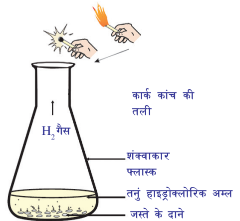
चित्र-2: जस्ते पर तनु हाइड्रोक्लोरिक अम्ल की क्रिया से \text{H}_2 गैस का बनना और \text{H}_2 गैस का परिक्षण
